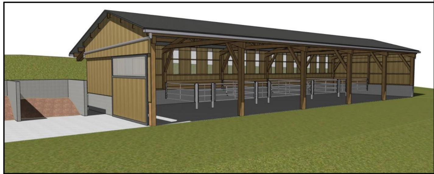
Projet: Construction d'un bâtiment en bois à usage d'écurie fermé sur 3 côtés, d'une surface d'emprise au sol créée d'environ 295 m<sup>2</sup> + zone de compostage composée de 3 box de 9 m<sup>2</sup>.
